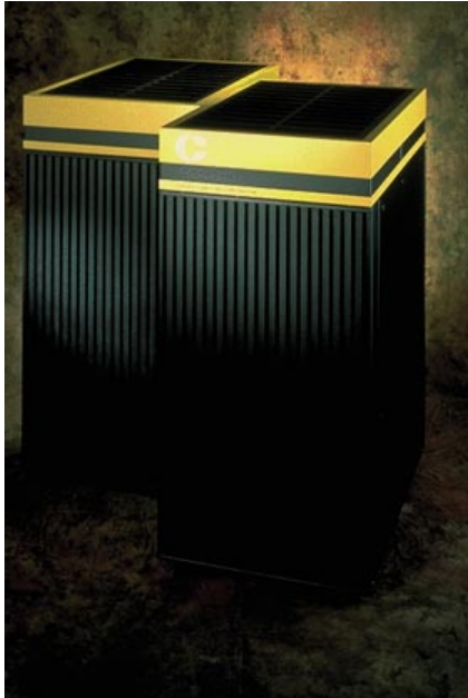
L'últim vectorial dissenyat per CONVEX: el C4 com a màxim podia tenir 4 processadors de 720 Mflop/s cadascun.
