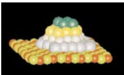
Un punt de la simulació per dinàmica molecular del creixement d’agregats de Pd sobre la superfície anterior. Hom pot apreciar l’estructura piramidal de l’agregat tot i que s’exhibeixen cares compactes de tipus (111).
