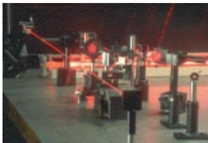
Sistema experimental de generació i control de feixos de llum soltònics, dissenyat numèricament al CESCA.
