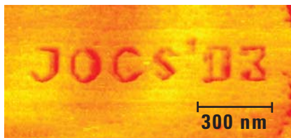
La paraula JOCS'03 escrita amb una micropalanca sobre una monocapa d'un compost orgànic depositat sobre mica atòmicament plana. La línia indica l'escala del dibuix (300 nm). Dibuix realitzat per Ismael Diez-Pérez.
