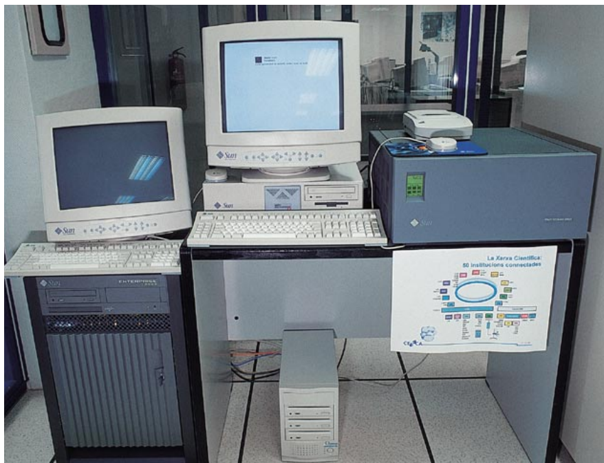
▲ La Sun E3500 (a l'esquerra, sota del monitor) que allotja el servei de proxy caché i l'autenticador de l'accés remot. Al costat, el servidor de news SunUltra2 .
